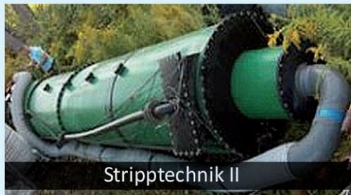
Komplette Mobile Einstufige Strippanlage mit Strippskolonne aus HDPE (inkl. Füllkörper), Strippsgebläse und Luftaktivkohlefilter-Container inkl. Aktivkohle.
